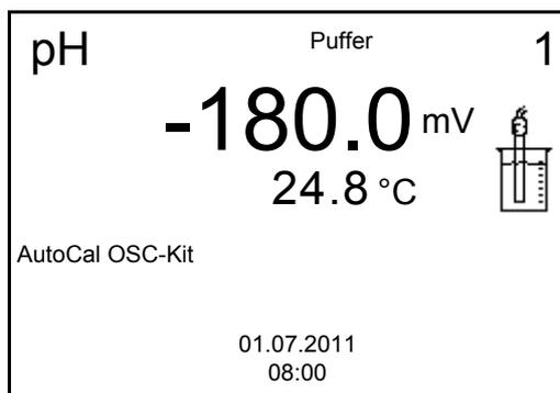
3. Die Kalibrierung mit den Puffern des QSC-Kit verläuft wie eine reguläre Dreipunktkalibrierung. Folgen Sie der Benutzerführung.
