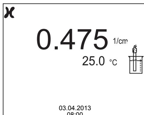
4. Den Leitfähigkeitssensor in die Kontrollstandardlösung  $0,01 \text{ mol/l}$  KCl tauchen.
