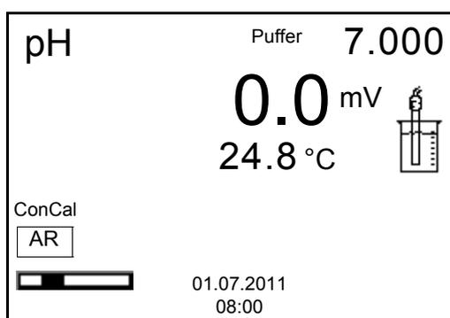
8. Das Ende der Messung mit Stabilitätskontrolle abwarten oder mit <ENTER> die Stabilitätskontrolle beenden und den Kalibrierwert übernehmen. Der pH-Wert der Pufferlösung wird angezeigt.
