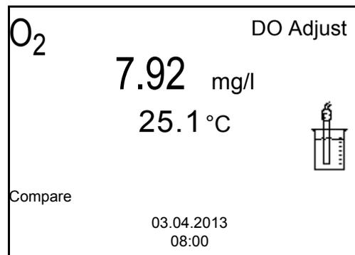
4. Mit **<ENTER>** die Messung starten. Der Messwert wird auf Stabilität geprüft (Stabilitätskontrolle). Die Statusanzeige [AR] wird angezeigt. Die Messgröße blinkt.
