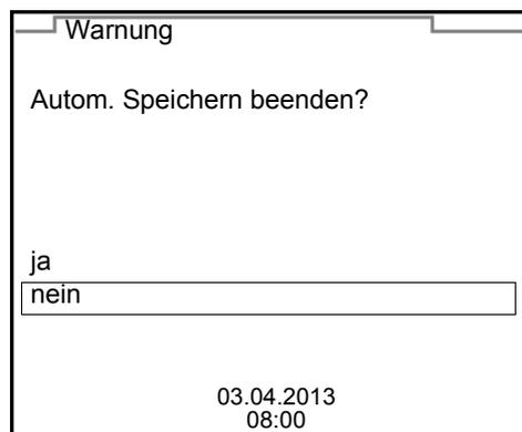
2. Mit **<▲><▼>** *ja* auswählen und mit **<ENTER>** bestätigen. Das Messgerät wechselt zur Messwertansicht. Das automatische Speichern ist beendet.
