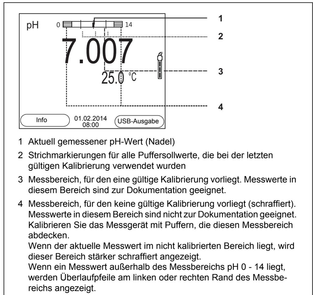
Die Grenzen des kalibrierten Bereichs sind durch die bei der Kalibrierung verwendeten Puffer bestimmt:
