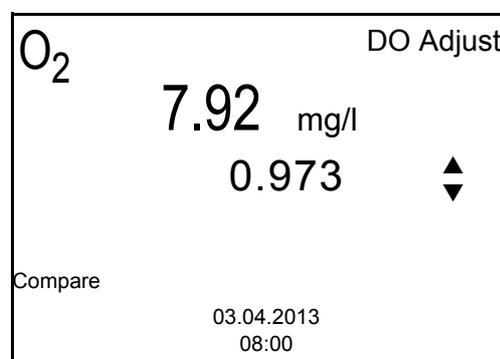
6. Mit **<▲>** **<▼>** den Korrekturfaktor so einstellen, dass der angezeigte Konzentrationswert dem Sollwert (Wert der Vergleichsmessung) entspricht. Anschließend Korrekturfaktor mit **<ENTER>** übernehmen. Das Messgerät wechselt zur Messwertansicht. Die Statusanzeige [*Factor*] ist aktiv.
